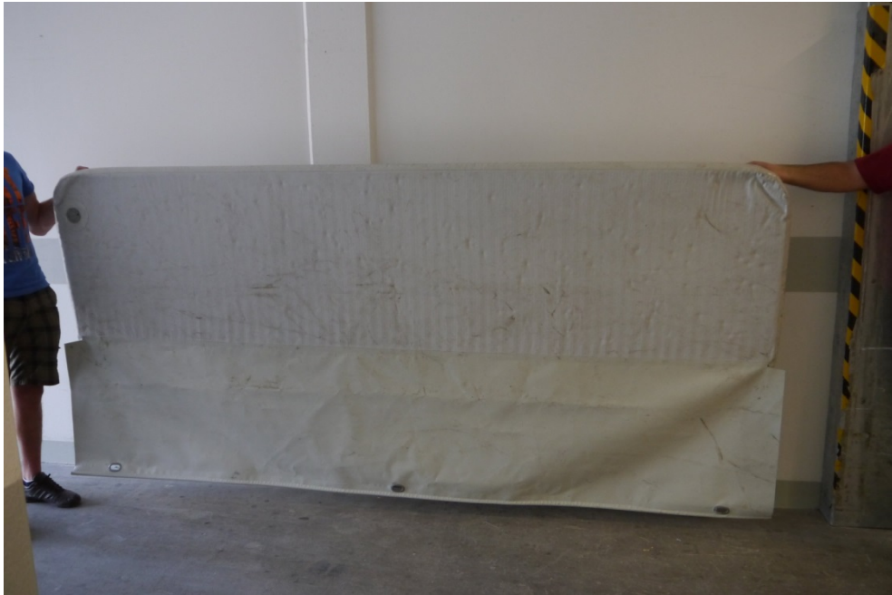
Abbildung B.1. Lärmschutzmatte aufgeblasen (Regelement), Anliegerseite.
