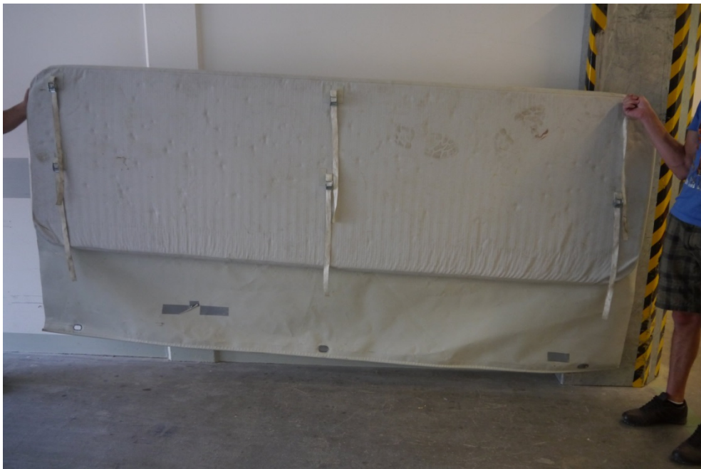
Abbildung B.2. Lärmschutzmatte aufgeblasen (Regelement), Schienenseite mit Befestigungslaschen.
