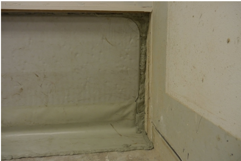
Abbildung B.8. Prüfaufbau im Wandprüfstand: Detail Abdichtung zum Prüfstand mit dauerplastischem Dichtstoff (empfangsraumseitig).
